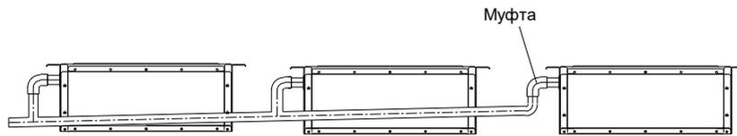
Параметры соединений дренажной трубы должны соответствовать производительности блока.
